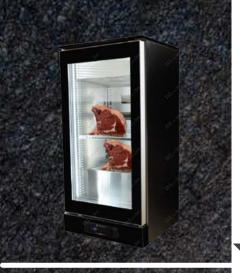
Vetrina frollatura carne - Maturatore -Temperatura -2° / +5°C - Controllo umidità dal 30% - 90% Struttura esterna in lamiera verniciata nera - Interno in acciaio AISI 304 -N°2 ripiani forati - Dimensioni cm 62 x 62 x 120 h
